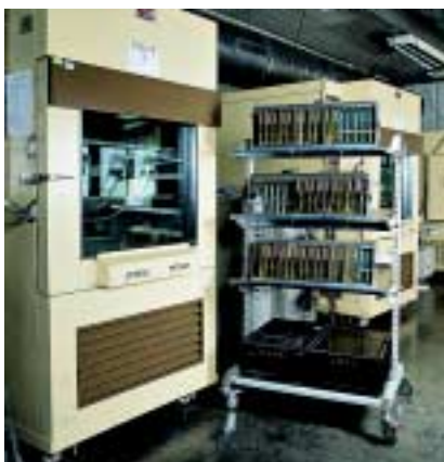
Sepam в камере температурных и вибрационных испытаний
